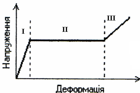
Рисунок 3.17 – Залежність напруження від деформації для кристалічного лінійного полімеру
